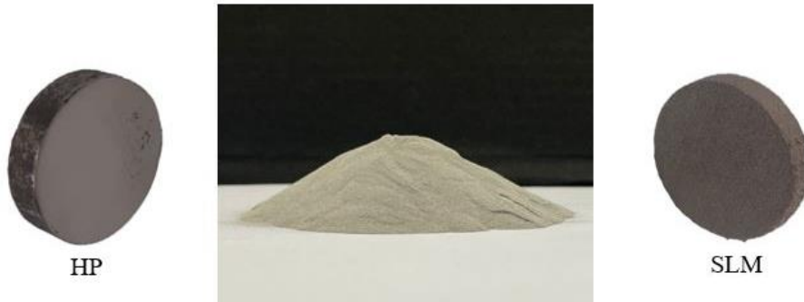
Şekil 2. HP ve SLM ile üretilen numunelerin ve kullanılan tozun makro görüntüleri (Numunelerin çapı 20 mm kalınlıkları 5 mm’dir)
