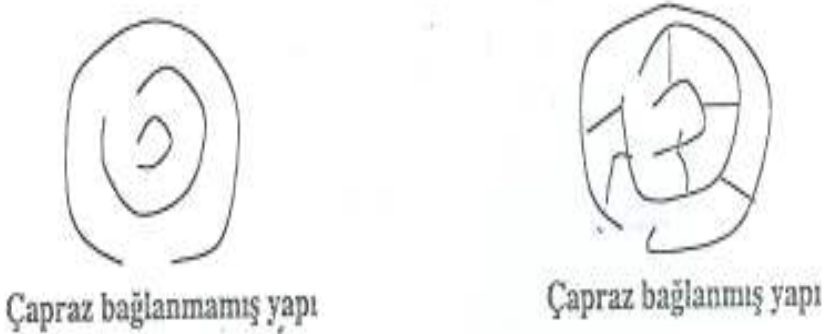
Şekil 3. Çapraz bağlanmamış ve bağlanmış polimer yapısı (Soyubol, 2006)
