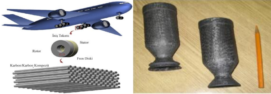
Şekil 3. Karbon temelli kompozit malzeme ile üretilmiş a) uçak iniş takımı fren diskleri ve b) roket yanma odası (Harussani vd., 2022)
