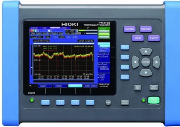
Şekil 3. Enerji tüketiminin belirlenmesinde kullanılan güç analizörü
